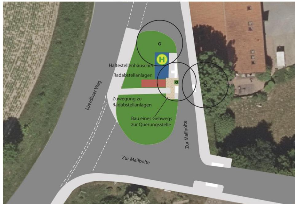
Erneuerung des Haltestellenhäuschens, Fahrradüberdachung und digitale Anzeigetafel, Ausbau der Haltestelle mit Anlegen eines Gehwegs (oben, Fotomontage: LK Argus; unten, Entwurfsskizze: LK Argus)
